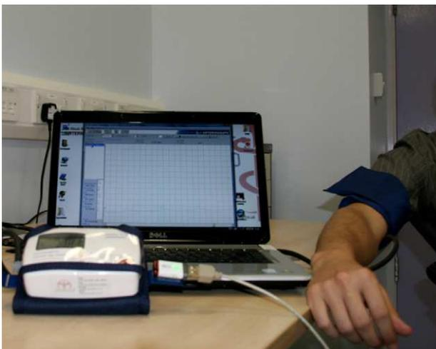
**Figura 7.** Dispositivo oscilométrico para determinar la velocidad de onda del pulso.
