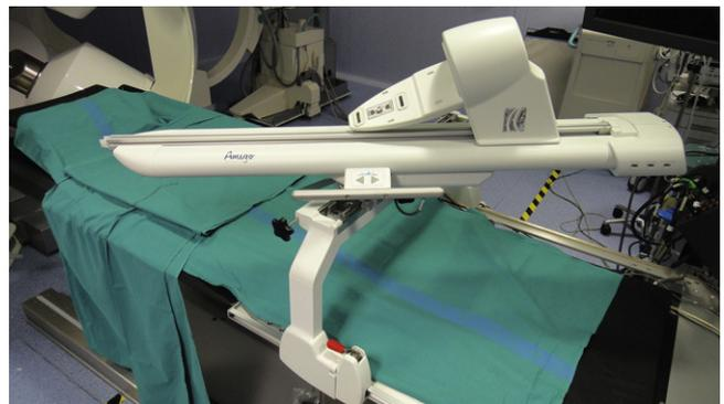
**Figura 1.** Brazo robótico sobre el que se sustenta el catéter de ablación en el Amigo™ Remote Catheter System. El mango del catéter se aplica sobre dicho brazo, introduciéndose la parte distal del catéter a través del introductor femoral. Los movimientos se transmiten al catéter a través del brazo robótico, desde una consola a distancia mediante un joystick.
