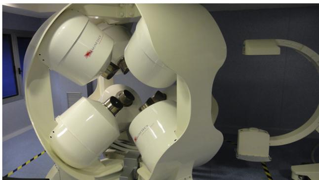
**Figura 2.** Imagen de los 8 electroimanes correspondientes al sistema CGCI® de Magnetec, entre los cuales se coloca la camilla con el paciente.
